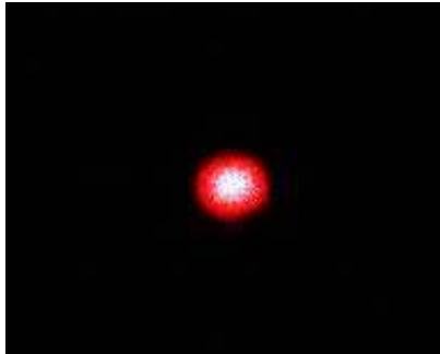
FIGURA 1. Fotografía digital del haz láser He-Ne, preparado mediante apodización.
