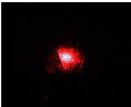
FIGURA 3. Fotografía digital del patrón de difracción producida por una capa muy delgada de tejido adiposo.
